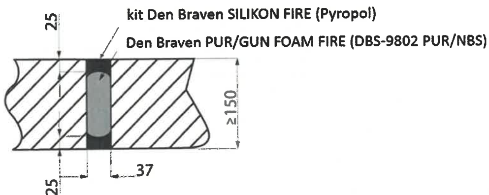
Rys. B2. Złącza liniowe uszczelnione I lub II zestawem. Typ 1b wg tablic 1 i 2
